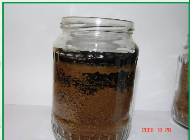
5.sz. ábra: enzimekcszítmény hozzáadása az olajjal szennyezett földhöz
