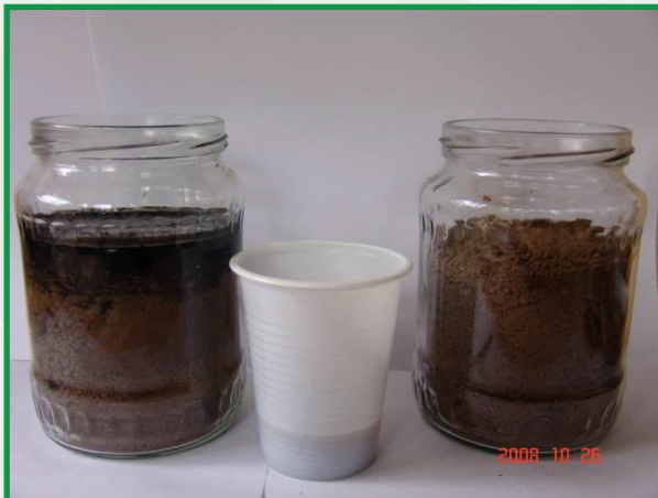
4.sz. ábra: olajjal szennyezett föld, enzimekcszítmény hozzáadása előtt
