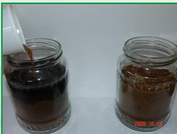
5.sz. ábra: enzimekcszítmény hozzáadása az olajjal szennyezett földhöz
