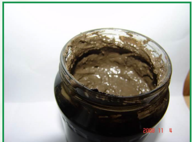
7.sz. ábra: élőkulturás enzimmészítménnyel kezelt olajjal szennyezett föld 10. nap
