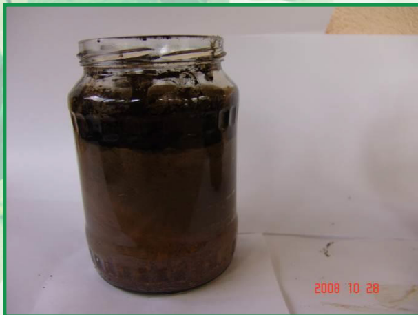
6.sz. ábra: élőkulturás enzimmészítménnyel kezelt olajjal szennyezett föld 3. nap
