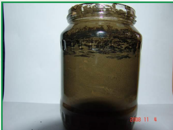
7.sz. ábra: élőkulturás enzimmészítménnyel kezelt olajjal szennyezett föld 10. nap
