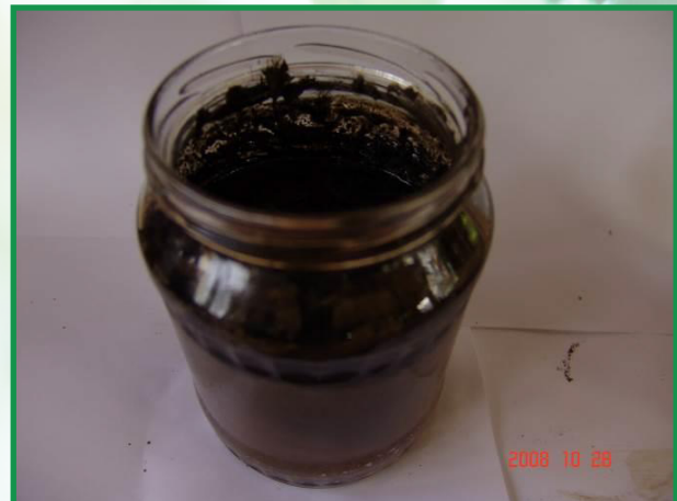
6.sz. ábra: élőkulturás enzimmészítménnyel kezelt olajjal szennyezett föld 3. nap
