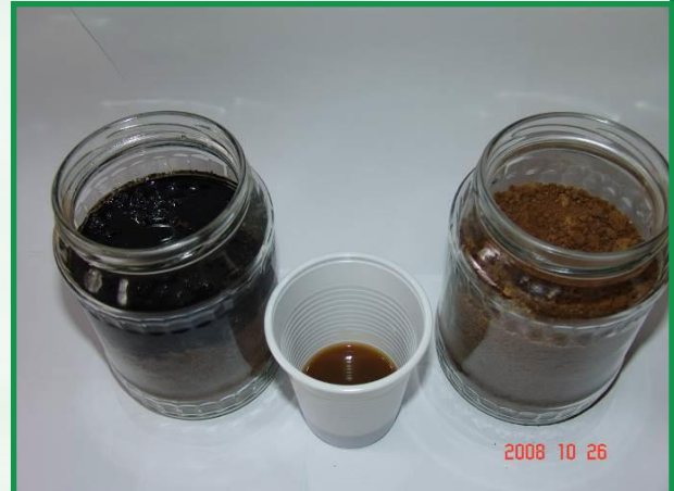
4.sz. ábra: olajjal szennyezett föld, enzimekcszítmény hozzáadása előtt
