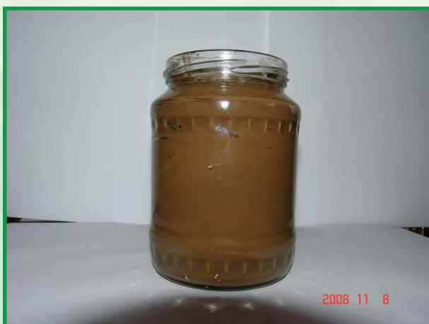
8.sz. ábra: élőkulturás enzimmészítménnyel kezelt olajjal szennyezett föld 14. nap
